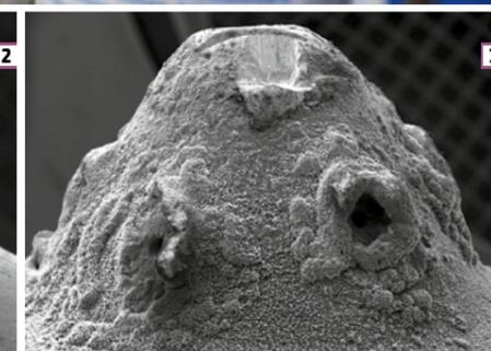
1. Chemie im Einsatz: Reinigende Treibstoffzusätze lassen die Ablagerungen an den Einspritzdüsen abplatzen. 2. + 3. Aufnahme einer Einspritzdüse durch das Elektronen-Rastermikroskop: Mit Ablagerungen (Bild 3) und gereinigt, nach der Additiv-Behandlung (Bild 2).
