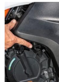
Einem vermeintlichen Konstruktionsfehler der KTM auf der Spur: Der Ölpeilstab wollte für eine Kontrolle partout nicht am Tank vorbei. Mittlerweile hat KTM den Peilstab durch einen normalen Schraubverschluss ersetzt. Zur Ölkontrolle genügt das Schauglas.
